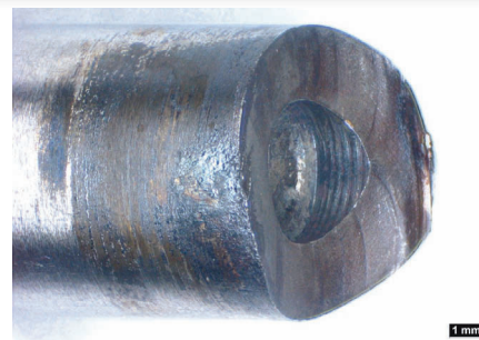
Gebrochener Kegelstift mit den Maßen 8 x 75 Millimeter.
